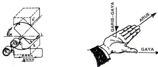
Gambar 4. Menentukan ggl pada Belitan Sebuah Generator
